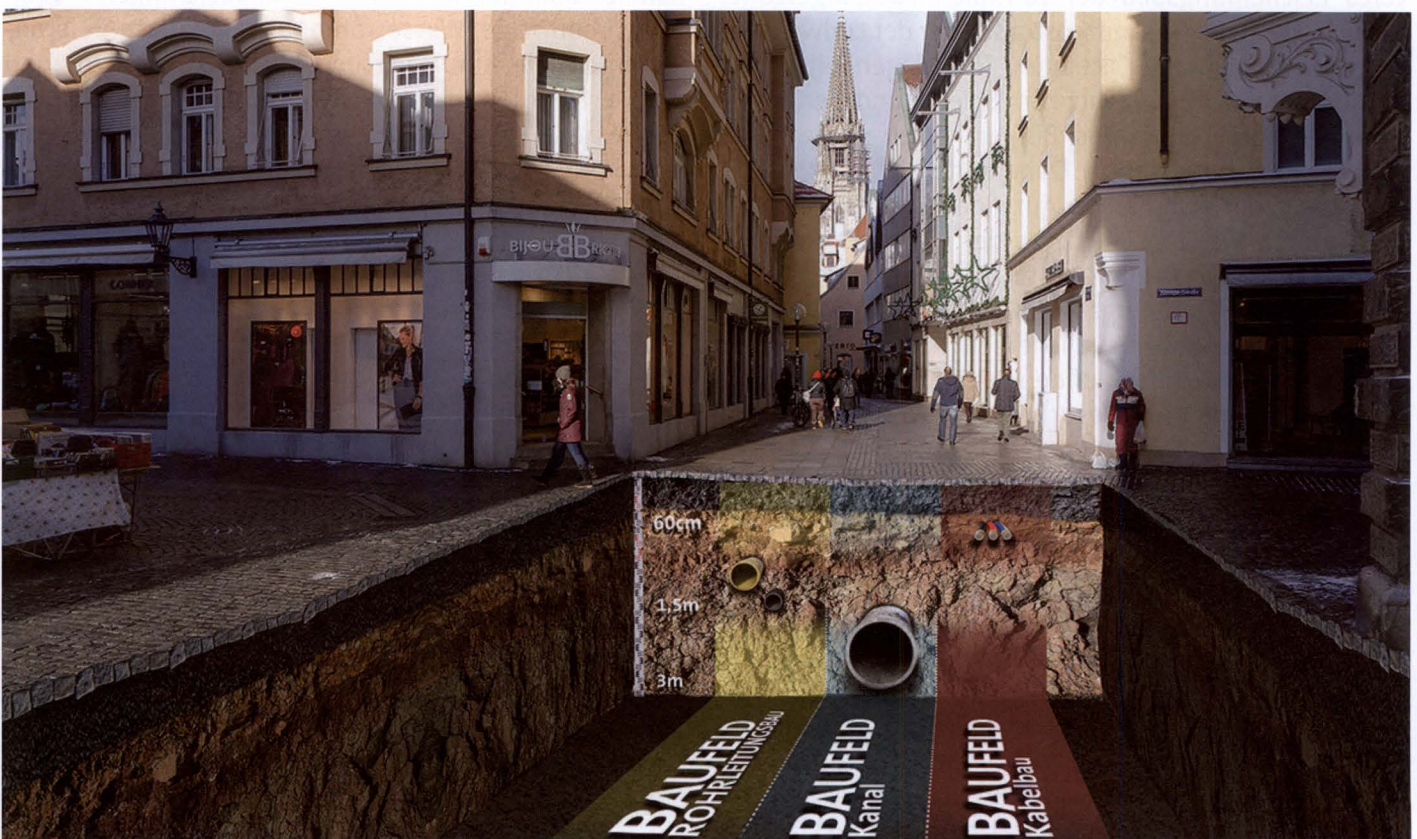
Insgesamt drei verschiedene Baufelder müssen unter der Erde bearbeitet werden: Die teilweise über 100 Jahre alten Abwasserkanäle, Rohre und Entsorgungsleitungen sowie Kabel für Strom, Telefon und Internet.
